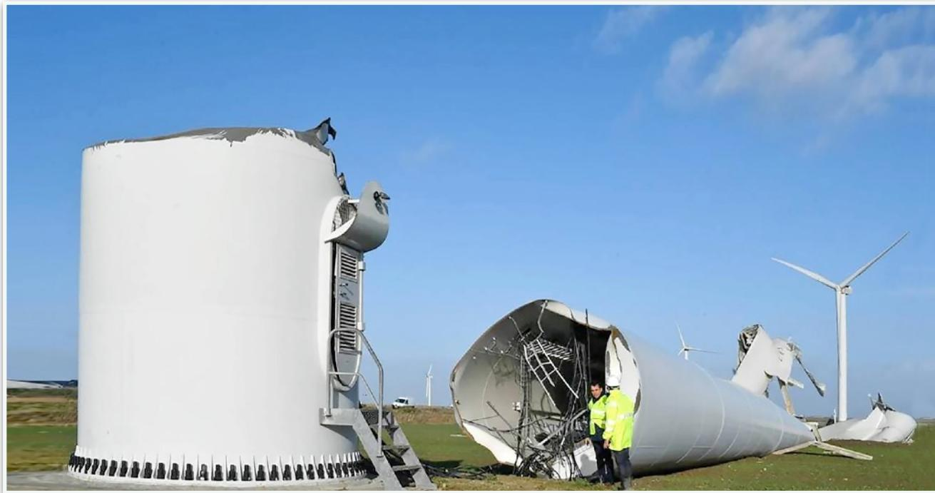
Sur ces trois éléments, un seul est parfaitement recyclable : les 210 tonnes d'acier, de cuivre et d'aluminium du mat et de la nacelle.
